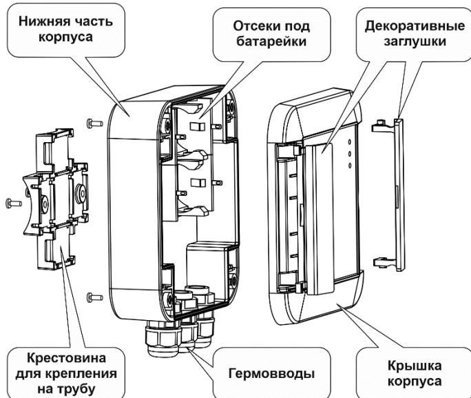
Рис.1. Конструкция терминала
